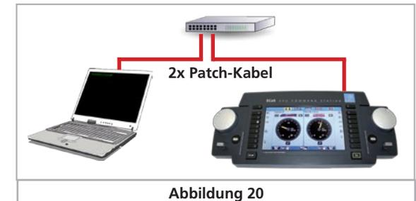
Benutzen Sie ein handelsübliches Netzwerkkabel (sog. „Patch-Kabel“) und verbinden Sie dieses mit einer freien Buchse Ihres Netzwerkschwitches oder -hubs. Die LINK-LED muss dann aufleuchten.
