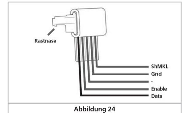
Die Belegung des Kabels ist wie folgt:
